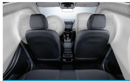
**Seis airbags.** Dos airbags frontales, dos airbags laterales de tórax integrados en los asientos delanteros y dos airbags de cortina para la protección de la cabeza y los impactos laterales.
